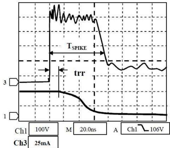
**Figure 3. Lead Edge Spike**
